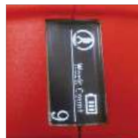
Электронный счётчик количества опрессовок
