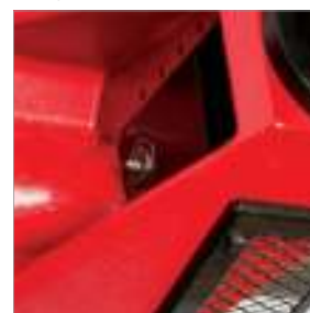
Отверстие для смазки
